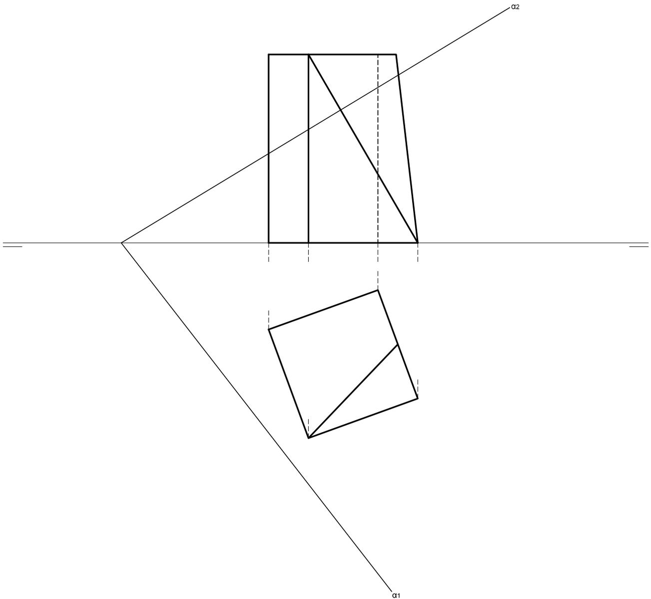
1. Hallar la sección producida en el cilindro por el plano  $\alpha$ , asv como los puntos de tangencia de la sección con las generatrices del contorno aparente de la proyección vertical del cilindro.
