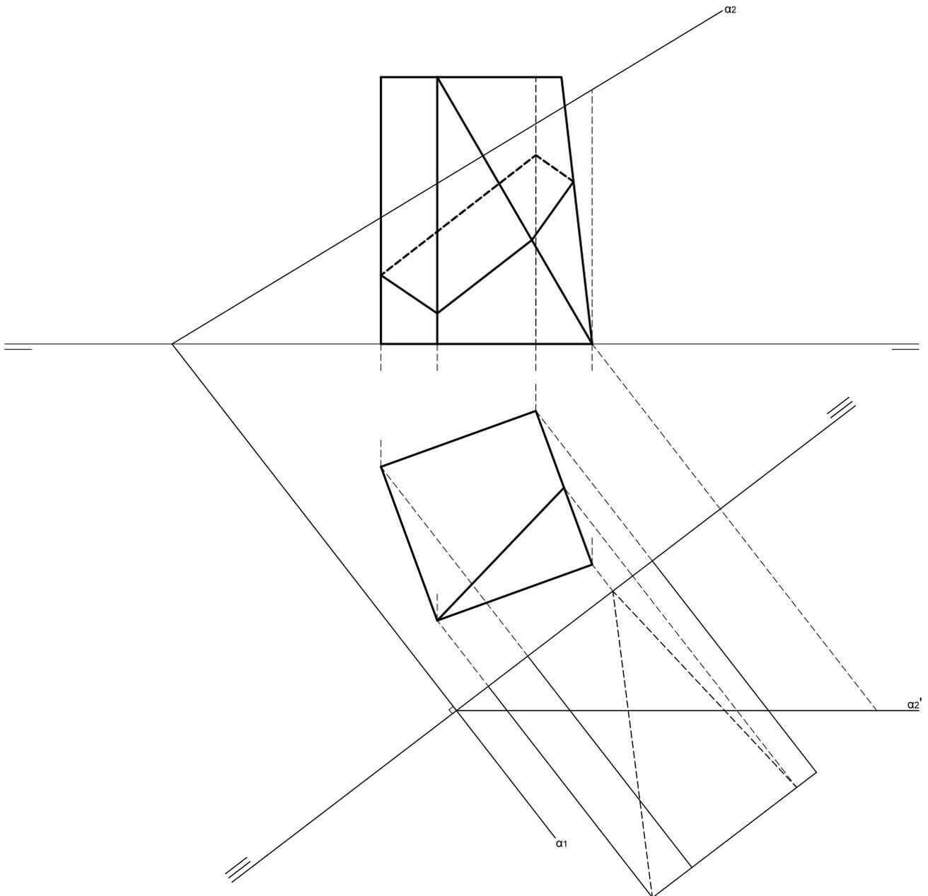
1. Hallar la sección producida en el cilindro por el plano  $\alpha$ , asv como los puntos de tangencia de la sección con las generatrices del contorno aparente de la proyección vertical del cilindro.
