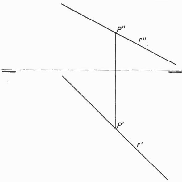
Determinar las proyecciones de los puntos pertenecientes a la recta  $r(r'-r'')$ , que distan, en magnitud real, 30 mm del punto  $P(P'-P'')$ . Aprovechar el cambio de plano para calcular el ángulo que la recta  $r$  forma con el P.H.
