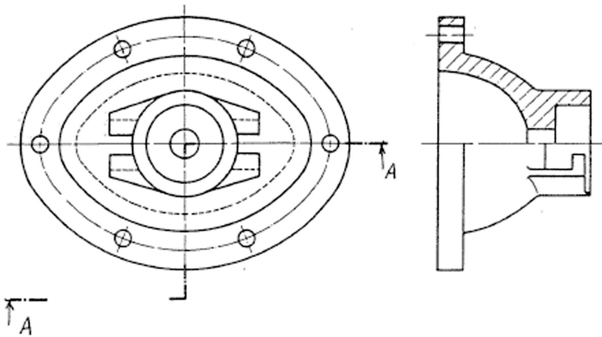
Dibuje el corte que se indica de la pieza representada por sus vistas diédricas.
