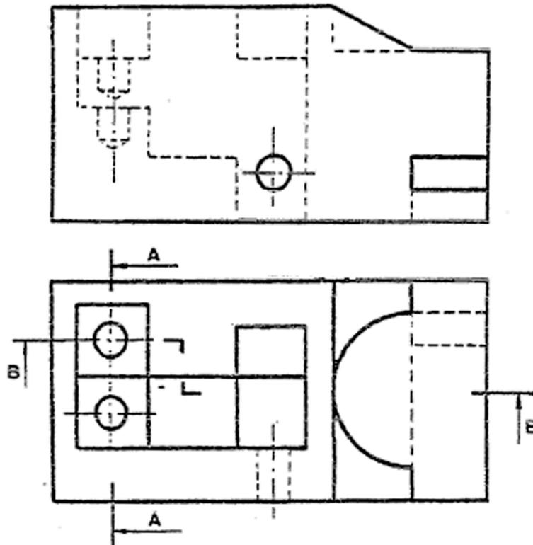
Dibuje los cortes que se indican de la pieza representada por sus vista diédricas.
