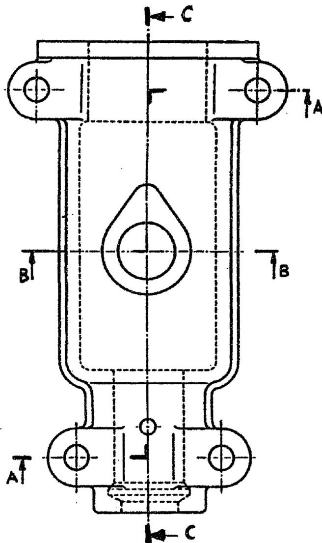
Dibuje la planta superior y el corte A-A de la pieza representada por sus vistas
