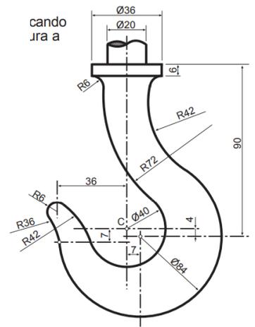
DIBUJA LA HÉLICE DE LA FIGURA MEDIANTE LAS CORRESPONDIENTES CURVAS DE ENLACE, SEÑALANDO LOS CENTROS Y LOS PUNTOS DE TANGENCIA.
