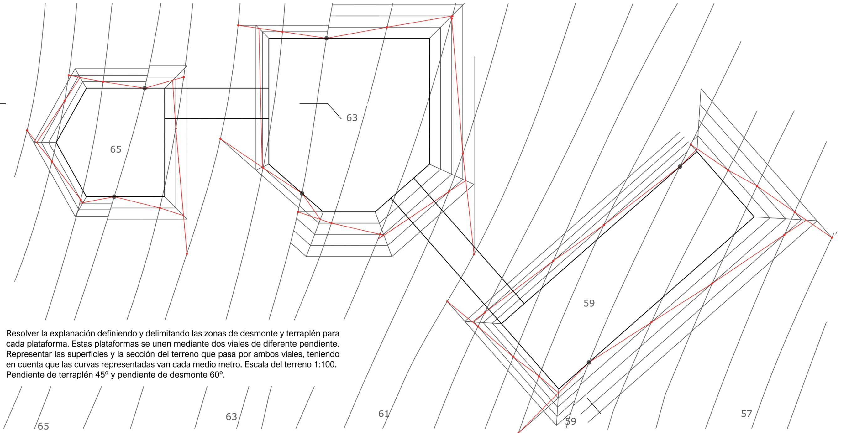
Resolver la explanación definiendo y delimitando las zonas de desmonte y terraplén para cada plataforma. Estas plataformas se unen mediante dos viales de diferente pendiente. Representar las superficies y la sección del terreno que pasa por ambos viales, teniendo en cuenta que las curvas representadas van cada medio metro. Escala del terreno 1:100. Pendiente de terraplén 45° y pendiente de desmonte 60°.
