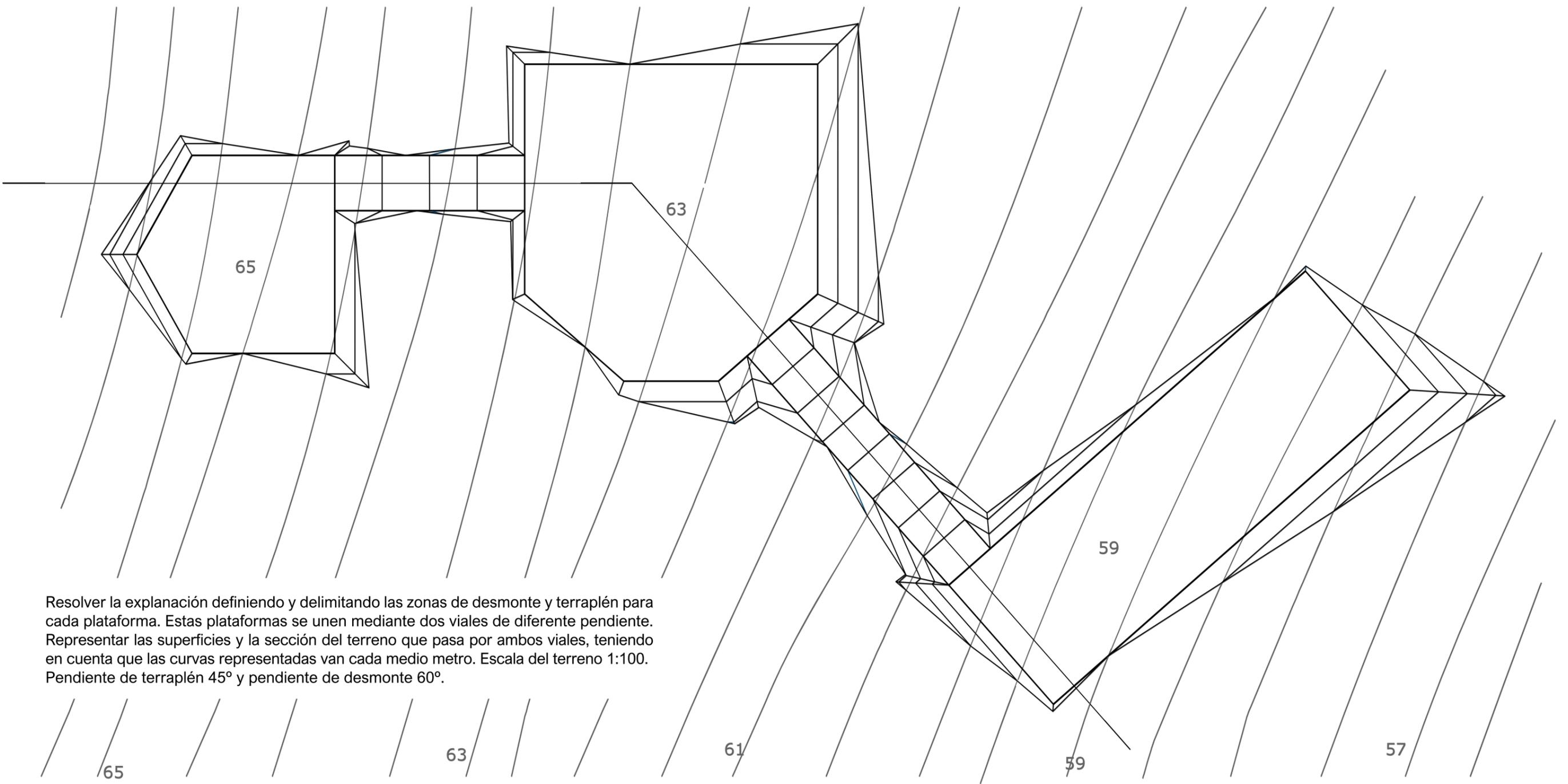
Resolver la explanación definiendo y delimitando las zonas de desmonte y terraplén para cada plataforma. Estas plataformas se unen mediante dos viales de diferente pendiente. Representar las superficies y la sección del terreno que pasa por ambos viales, teniendo en cuenta que las curvas representadas van cada medio metro. Escala del terreno 1:100. Pendiente de terraplén 45° y pendiente de desmonte 60°.
