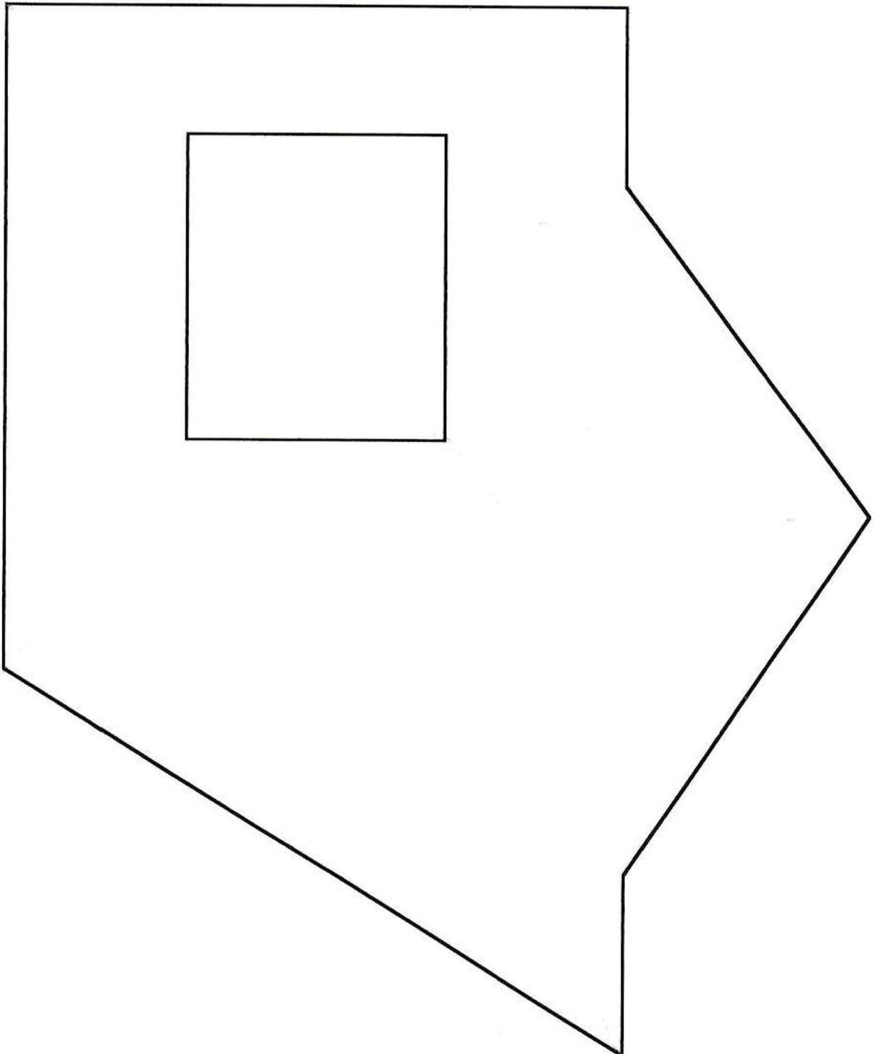
El contorno de la planta de un edificio coincide con el croquis dibujado. Tanto el perímetro exterior como el de los patios se encuentran a una cota de 5m. Representar la cubierta del edificio con las líneas de nivel a una equidistancia de 1m. La pendiente de los planos  $\alpha$  es de  $2/3$  y de los planos  $\beta$  es de  $1/1$ . Escala 1/100.
